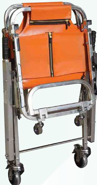
• Chaise permettant l'évacuation à partir d'endroits difficiles comme les escaliers ou les couloirs étroits. La chaise possède: une structure en alliage d'aluminium. 4 poignées réglables en hauteur et en longueur. Un système de verrouillage de sûreté automatique lorsque la chaise est repliée. 4 roues pivotantes. 3 sangles avec boucle à dégagement facile. Une pochette. Revêtement vinyle.
