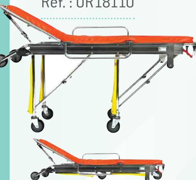
• Structure en aluminium anodisé. Quatre roues diamètre 125 mm dont deux pivotantes avec centrage automatique. Hauteur réglable. Plan en thermoplastique renforcé permettant d'effectuer un massage cardiaque. Dossier inclinable, deux barrières latérales rabattables. Système de blocage des pieds en position repliée. Levier de sécurité situé près de la poignée de déblocage permettant le chargement tout en gardant les mains sur le brancard.
