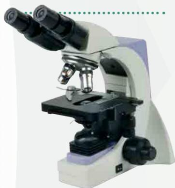
Microscope Mixte pouvant être utilisé avec ou sans éclairage en substituant le bloc "éclairage" par le miroir et son support.
